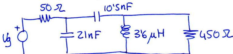
Això ens és útil, ja que normalment, quan posem una xarxa d'adaptació, no sabem la funció que fa aquesta part de circuit ('a part d'adaptar impedàncies'). Amb aquest circuit, almenys sabem que fa de filtre pas baixa.
