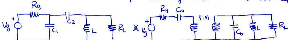
Sabem que una de les funcions del transformador és adaptar impedàncies. Perquè aquest circuit funcioni així, ens interessarà que  $C_a$  sigui gran (així la seva impedància podria ser petita respecte la  $R_g$ ) i que les impedàncies de  $C_b$  i  $L$  es cancel·lin.
